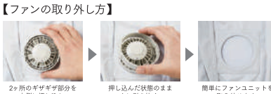
2ヶ所のギザギザ部分を内側に押し込む。 押し込んだ状態のまま上に引き抜く。 簡単にファンユニットを取り外せます。
